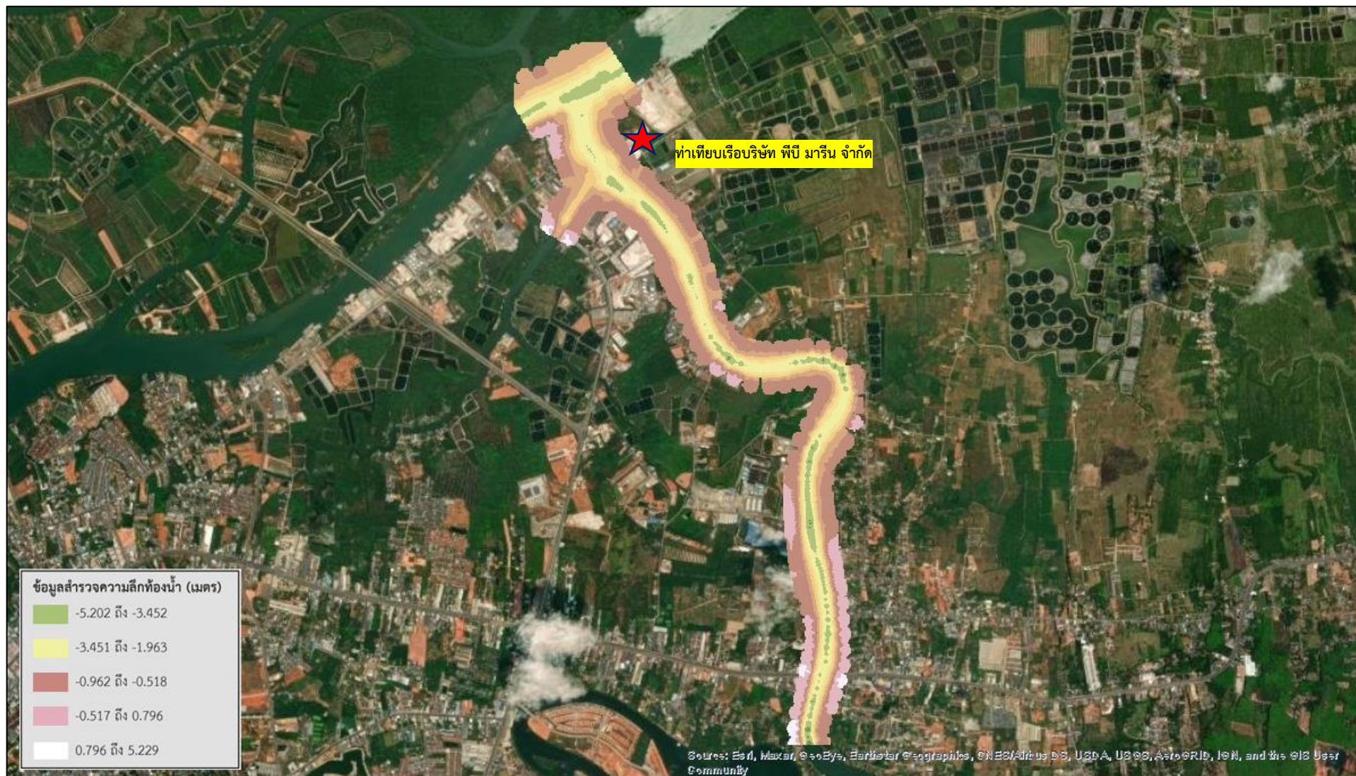
รูปที่ 3.1.8-43 ข้อมูล DEM จากข้อมูลสำรวจความลึกท้องน้ำบริเวณพื้นที่โครงการ
