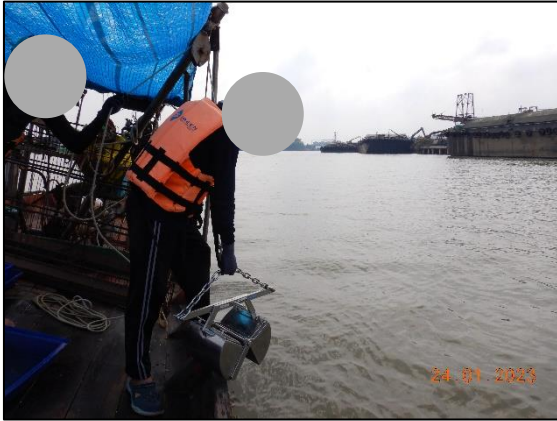
การเก็บตัวอย่างตะกอนดิน ดำเนินการโดยใช้ Peterson Grab Sampler ขนาดพื้นที่หน้าตัด 0.13 ตารางเมตร
