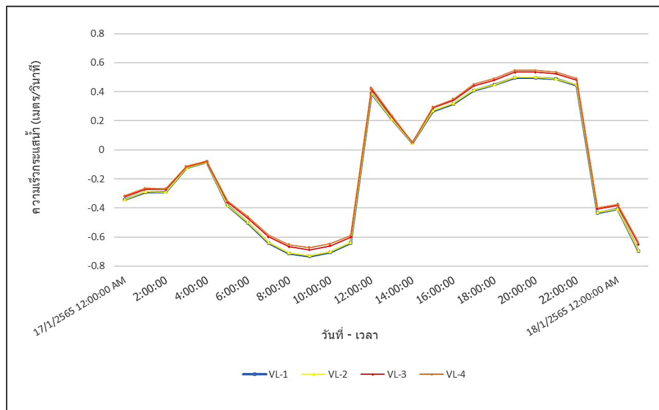
รูปที่ 3.1.8-36 ผลการตรวจวัดความเร็วกระแสน้ำ ณ ตำแหน่ง VL-1, VL-2, VL-3 และ VL-4 (ช่วงฤดูน้ำแล้ง)
