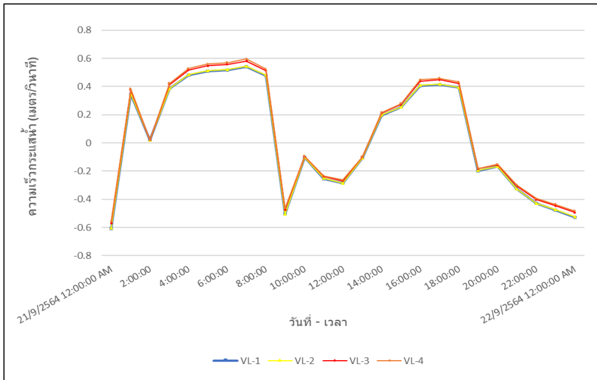
รูปที่ 3.1.8-49 ค่าความเร็วกระแสน้ำ ณ ตำแหน่ง VL-1, VL-2, VL-3 และ VL-4 ในฤดูน้ำหลาก
