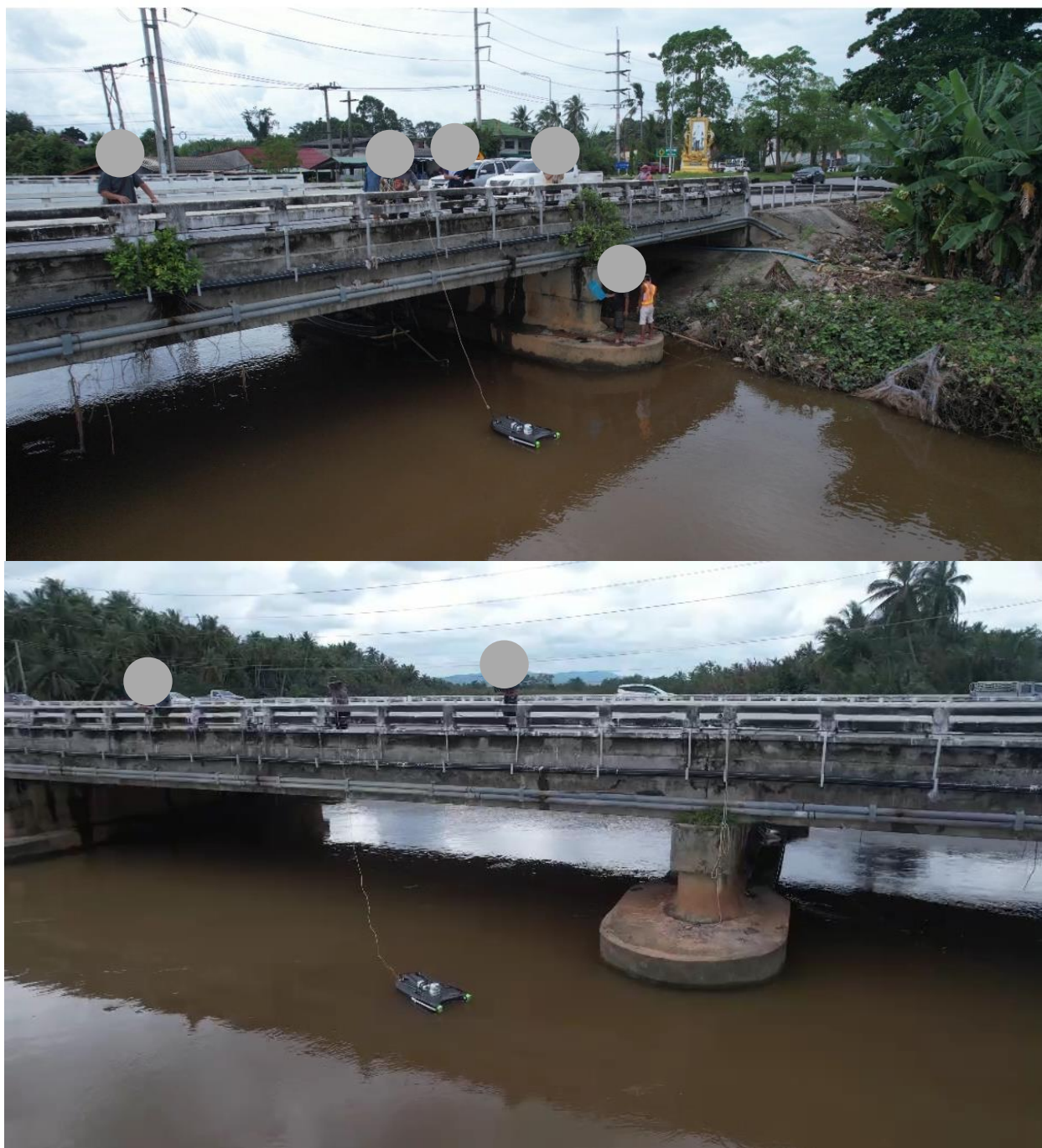
รูปที่ 3.1.8-10 ดำเนินการตรวจวัดเครื่องวัดกระแสไฟฟ้าแบบคลื่นเสียง “SonTek RiverSurveyor รุ่น M9” เพื่อการสอบเทียบในแม่น้ำเทพา บริเวณสะพานพระพุทธร ตำบลเทพา อำเภเทพา
