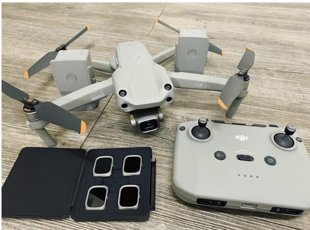
รูปที่ 3.1.8-12 อุปกรณ์ที่ใช้ในการสำรวจ เครื่องบินเล็กไร้คนขับยี่ห้อ DJI รุ่น Mavic Air 2S
