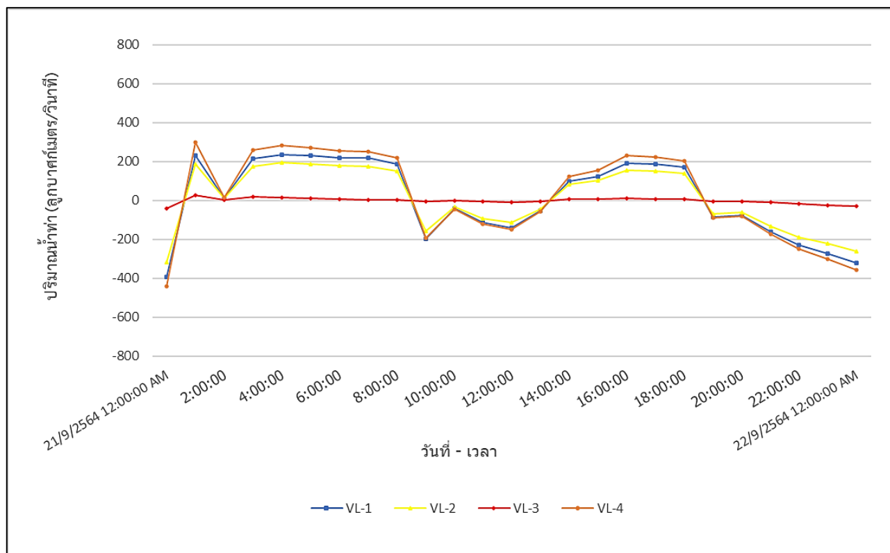
รูปที่ 3.1.8-39 ผลการตรวจวัดปริมาณน้ำท่า ณ ตำแหน่ง VL-1, VL-2, VL-3 และ VL-4 (ช่วงฤดูน้ำหลาก)
